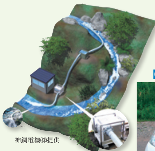
【小規模水力発電設備】
