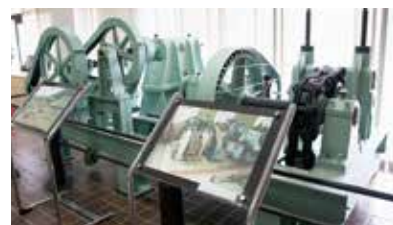
山王海ダムの管理事務所内には、旧ダムの取水塔で使われていたゲートの巻き上げ機が展示されている
