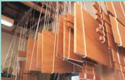
切り出した材料は、両側から均一に空気を当て、木本来のクセを出す。「乾燥させては削る」という作業を辛抱強く繰り返して、動きが止まったところで設計した寸法に切りそろえる。
