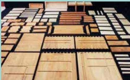
船筆筒の部材。この他、手作りの木釘や鉄釘、金具が使用され、全1200もの部品から組み立てられる。
