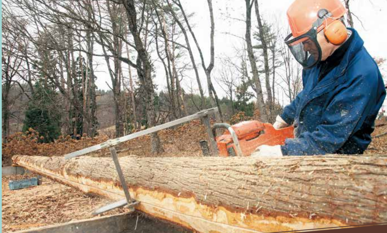
開発した器具をチェーンソーに取り付けて、10mの木材を半割りにする藤原さん
