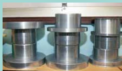
へら絞り加工で作られた製品。 レントゲンの機器の一部として使用される
