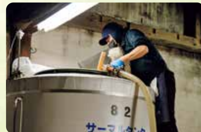
米・水・米こうじをタンクに入れて、発酵を促し「麴」をつくる
